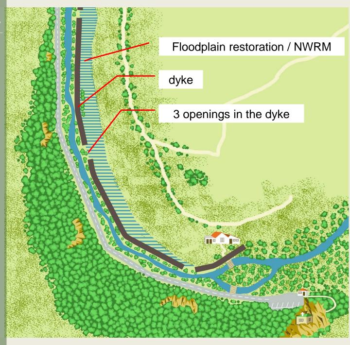
Russenski Lom Обект: "Възстановяване коритото на река Русенски Лом в района на с. Иваново" restoration Напречни профили plans Dyke opening in  $ML = 1:500 \quad MV = 1:100$ three places at 1 /rope/ Асфалтов път different ground 44.05 Съществуваща Съществуващ levels Ниво на прорязване 2 /долу/ Асфалтов път 43.30 Съществуваща Съществуващ Ниво на прорязване Разрез през прореза на дигата M 1:100 Корона дига Корона дига
