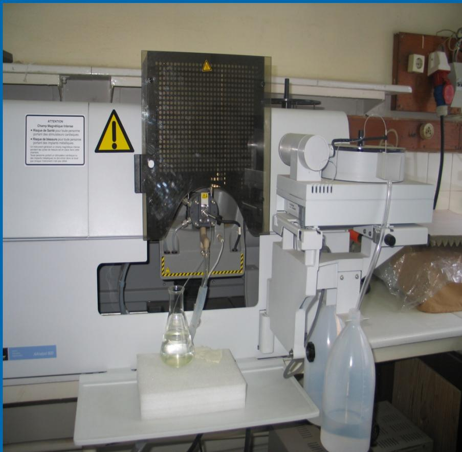
**Spectromètre d'absorption atomique AA800
