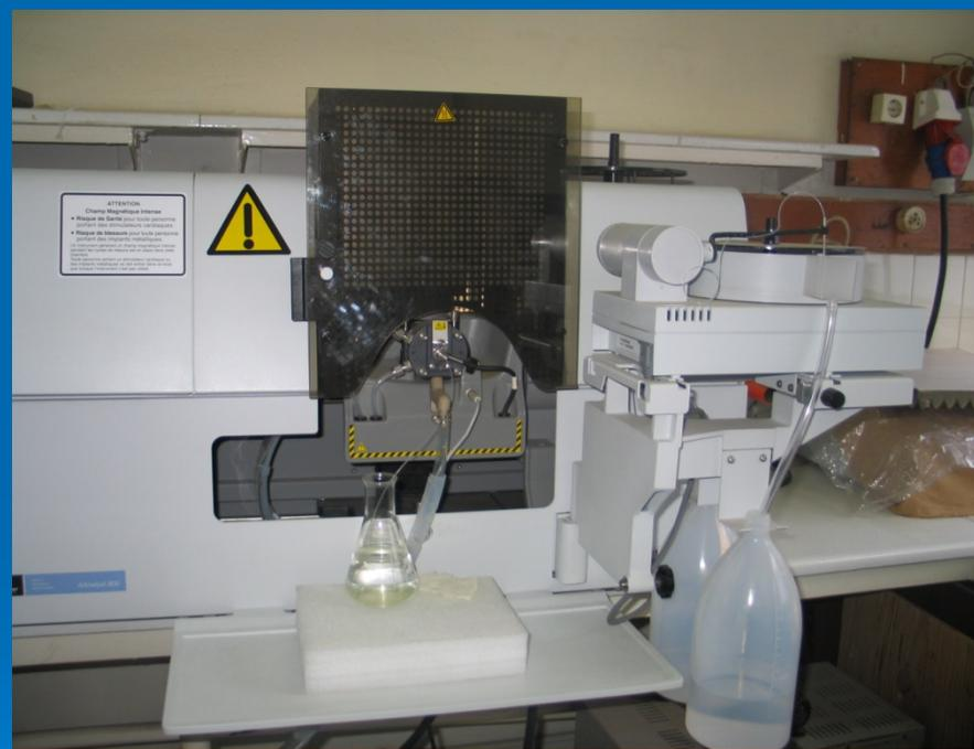
**Spectromètre d'absorption atomique AA800 pour le dosage des métaux lourds**
