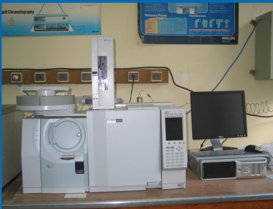
**Chromatographe CPG/SM pour le dosage des hydrocarbures et pesticides**
